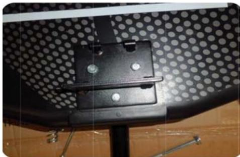
Присоедините держатель кольца (металлическую пластину) путем завинчивания болтов M6x30мм- 3шт.
